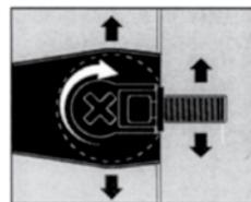
En verrouillant le came, celui-ci crée une pression sur le boîtier et sur le goujon qui assure une installation à toute épreuve.
