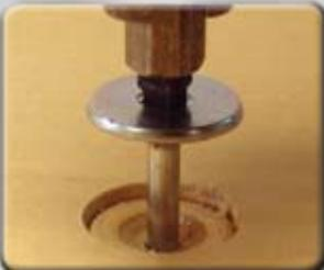
4. Insérez une vis à tête renforcée "Powerhead"
