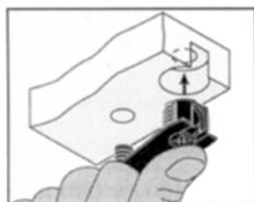
Les boîtiers s'insèrent dans le matériel d'une simple pression du doigt.
