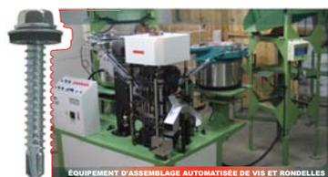
UCAN offre l'assemblage automatisé de plusieurs types de vis et rondelles à face d'EPDM ou de néoprène.
