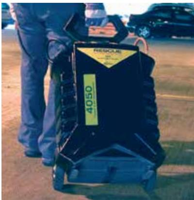
Les deux modèles ont des pneumatiques rigides, des pincés de grande capacité et une poignée ergonomique
